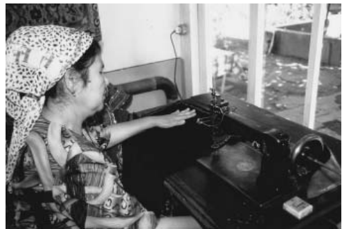
図22 1924年ドイツ製足踏みミシンを電動に改造 タシケント 2004年筆者撮影
